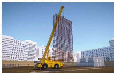
Modélisation du ferrailage des parois d'une gare de la Ligne 15 Sud
